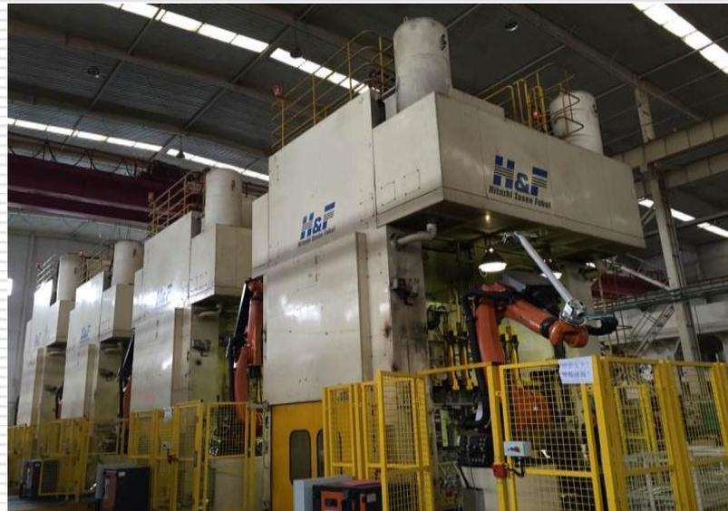
2000T自动化冲压生产线
