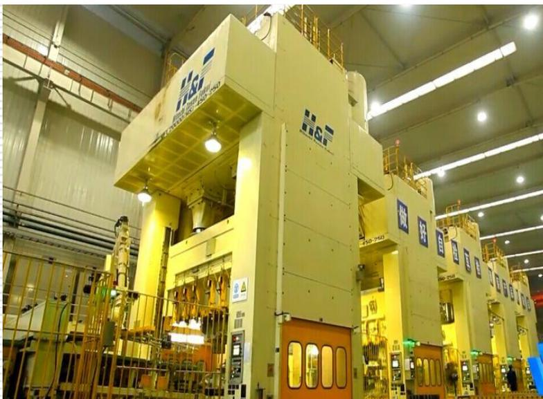
**2000T自动化冲压生产线**
