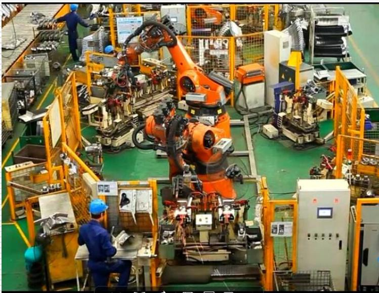
机器人焊接生产线
